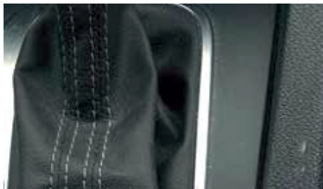
Zanedbateľné poškodenie povrchu potiahnutého umelou hmotou
