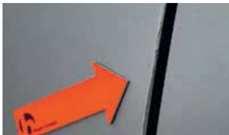
Mierne poškodenie laku na hrane dverí
